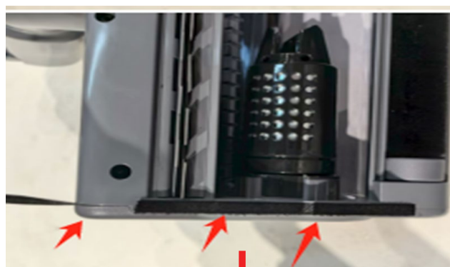
9. Relâcher la partie capuchon d'extrémité
