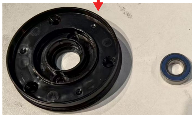
9. Relâcher la partie capuchon d'extrémité
