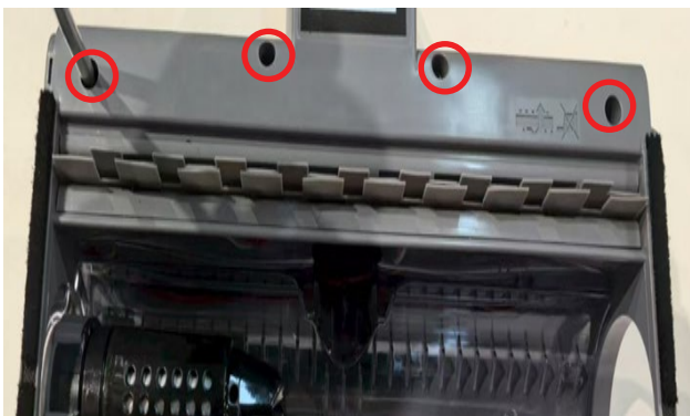
12. Retirer les quatre vis
