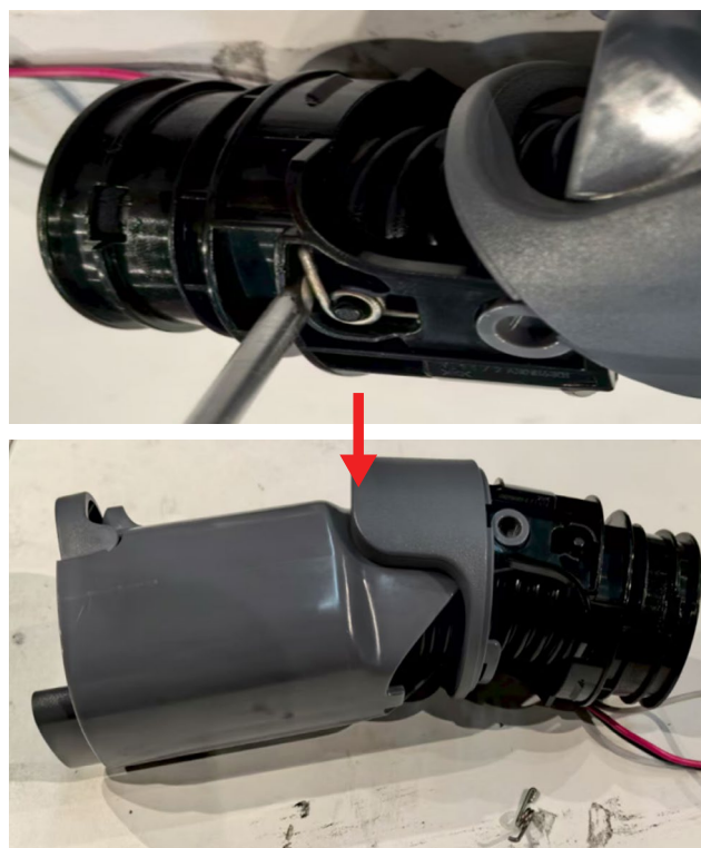
57. Relâcher le connecteur inférieur situé à l'intérieur de la garniture
