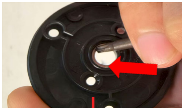
8. Retirer le palier de butée
