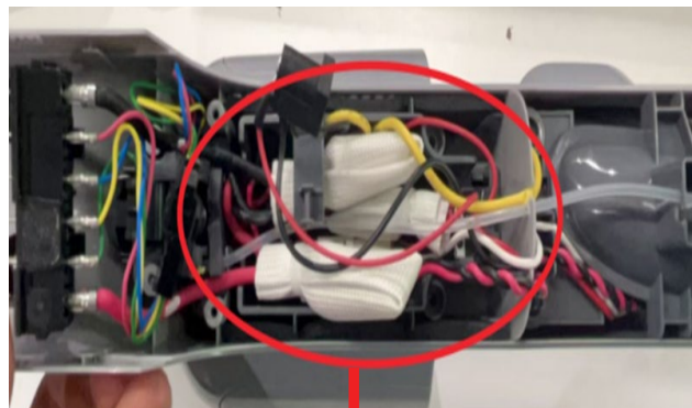
24. Retirer le câble des fentes
