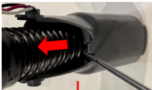
62. Relâcher l'ensemble de tuyau surmoulé
