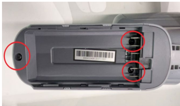
14. Retirer huit vis de l'unité manuelle
