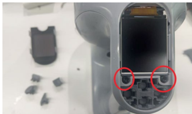
37. Relâcher le boîtier et retirer l'ensemble moteur de celui-ci
