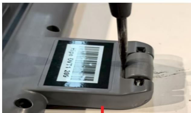
50. Relâcher la roue arrière et l'arbre
