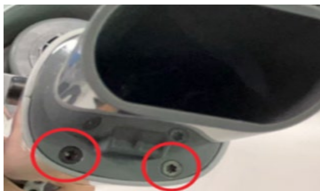
15. Retirer les deux vis situées à l'avant
