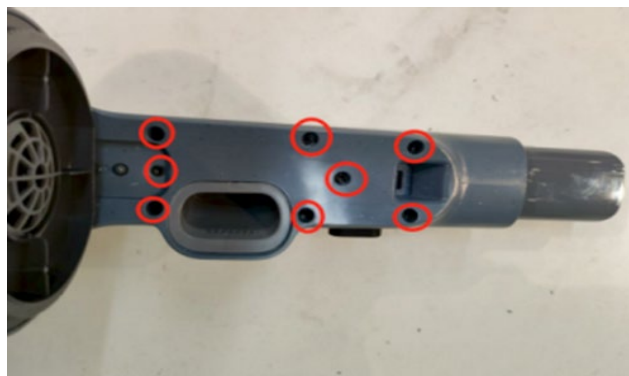
15. Retirer les deux vis situées à l'avant
