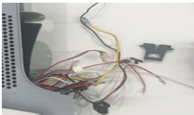
34. Relâcher la pièce de protection du câble (pièce en caoutchouc)
