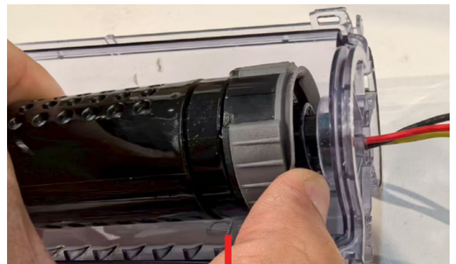
43. Relâcher l'ensemble moteur de l'embout
