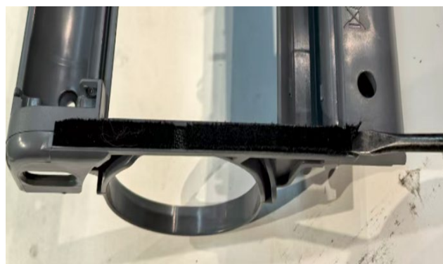
53. Relâcher le joint du connecteur inférieur
