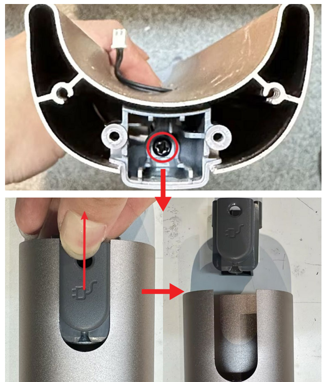
16. Retirer la vis, puis retirer le couvercle
